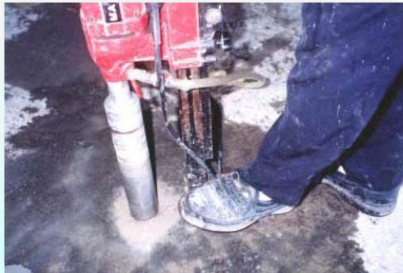
手提式之混凝土鑽心取樣機
