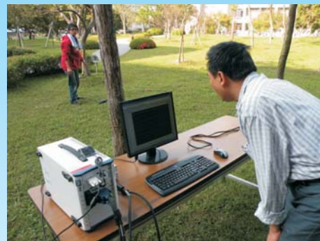
多頻道震測儀 非破壞檢測研究
