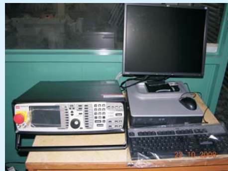
MTS數位控制器系統 結構系統模擬研究
