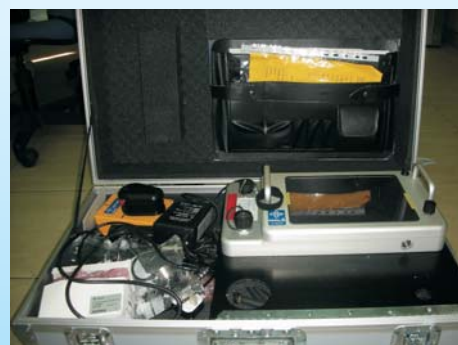
高頻透地雷達天線控制主機 非破壞檢測研究
