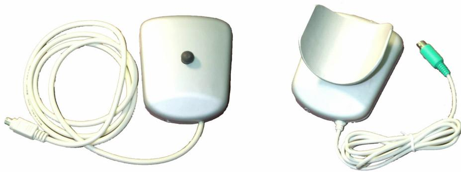
圖3.3 (左)點壓式與(右)承接座式 兩款改良之力感測滑鼠外觀
