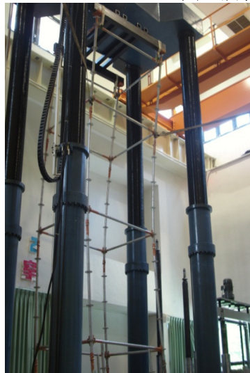
未裝設斜撐之 1.8m x 1.5m 支撐架強度為 7.413 噸
