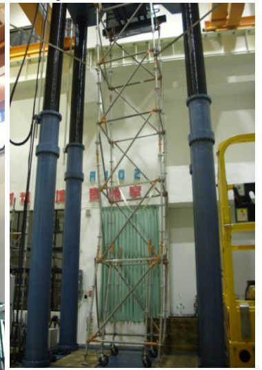
有裝設斜撐之 1.5m x 1.2m 支撐架強度為 40.95 噸
