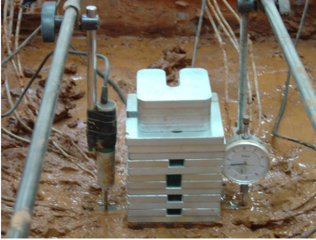
照片 1 載重塊與 LVDT 及變位計
