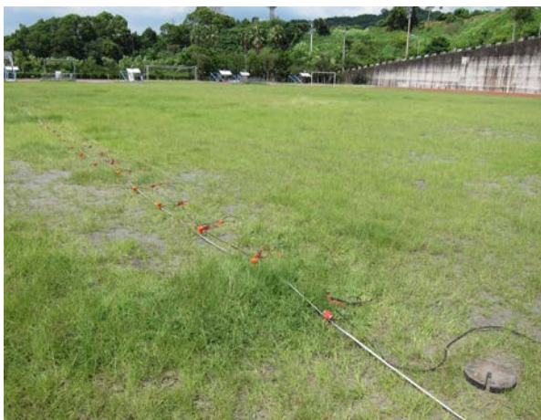
圖2 MASW現場佈線
