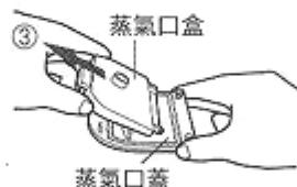
3. 將蒸氣口墊圈從切槽中取出
