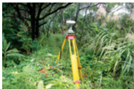
衛星定位接收儀：衛星定位技術具有準確、快速、即時、可同步施作等優勢。只要將接收儀放置在戶外沒有遮蔽的地方，即可接收到訊號。
