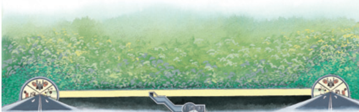
雪山隧道群由2座主坑、1座導坑及橫向的36座聯絡隧道所組成。遇突發事故時，可透過導坑自兩端洞口逃生。
