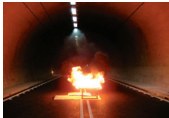
火盆試驗：將5L汽油倒入1m 2 之火盆(距地面高度50cm)內，點燃後以3~6m/sec的風速進行模擬。主隧道火警系統須於85sec內發出火災警報才算是測試成功。
