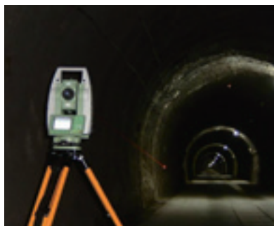
電子式經緯儀：用以量測平面座標。
