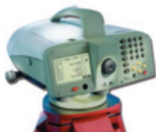
電子式水準儀：用以量測高程座標。
